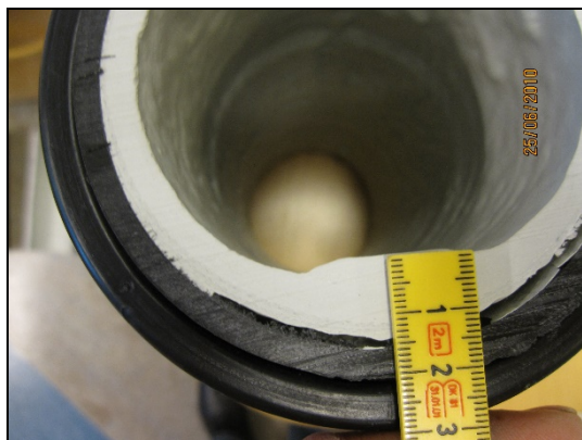
Fig. 65: Eksempelmåling av beleggetykkelse
