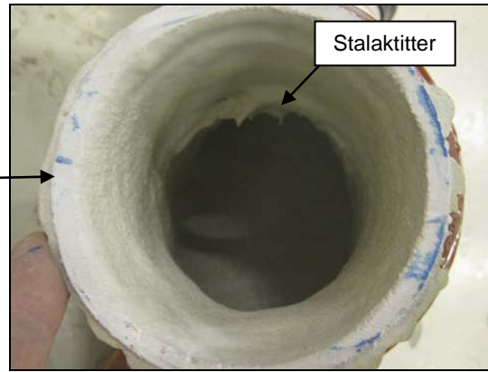
Fig. 46: Sprøytemetoden – stalaktitter i grenrør
