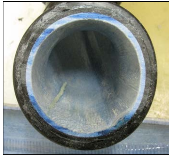
Fig. 64: Eksempel tverrsnitt – strøpemetoden
